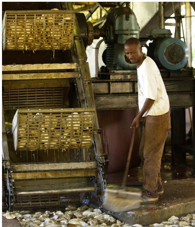
Photos de gauche à droite : le caoutchouc est lavé de ses impuretés ; puis transformé en granulés ressemblant à du pop-corn et compacté en feuilles ; il est ensuite moulé, chauffé et coupé en balles de couleur dorée d'un poids de 35 kg. Les balles sont enveloppées et chargées sur des palettes prêtes à être exportées.
